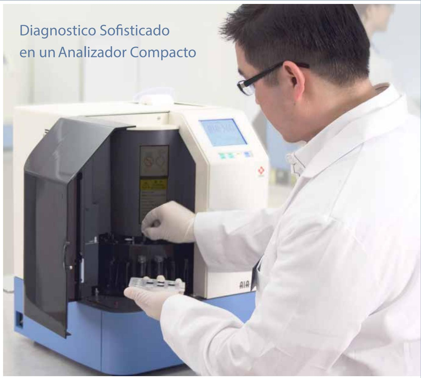
AIA-360<sup>®</sup> ANALIZADOR DE INMUNOENSAYO AUTOMATIZADO
